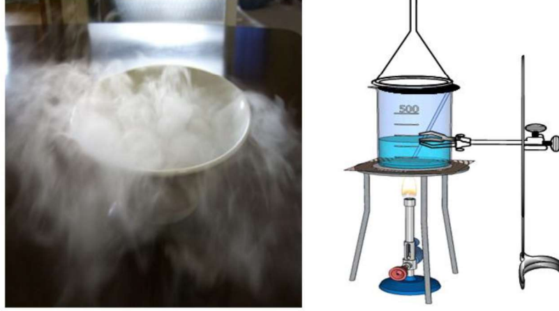
Şekil 10.3 Süblimleşme olayı ve naftalinin süblimleşmesine ait deney düzeneği
